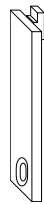
Placa de tope (para evitar la posición oscilo en la manilla) Ref. 0300-V (*)
